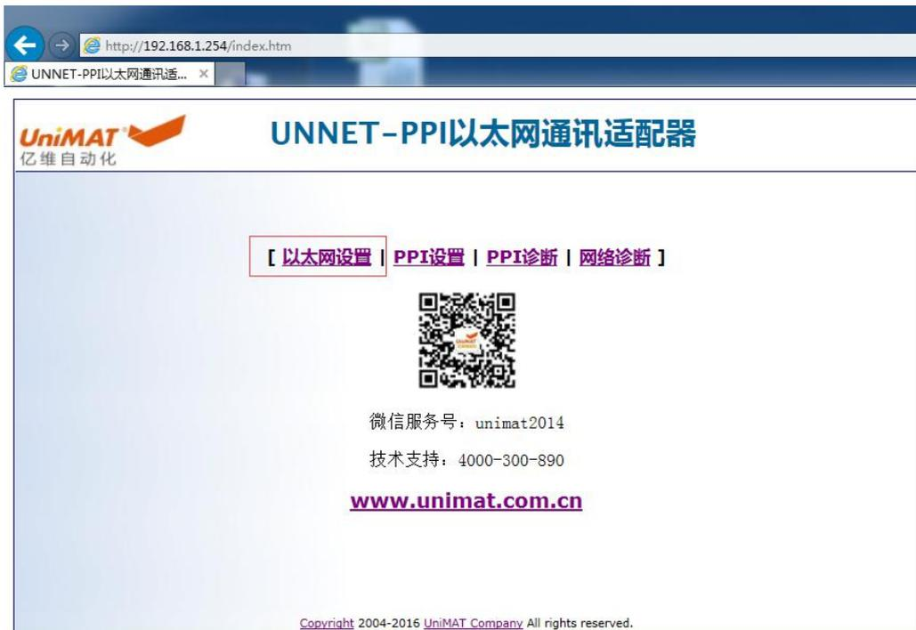
打开网页中的网络设置，默认设置 IP 地址为 192.168.1.254。如果前面调整了电脑的本地 IP 地址前三级数字，可以在此页面设置 IP 地址前三级与电脑本地网卡的原 IP 地址一致，再调整电脑本地 IP 地址回原。
