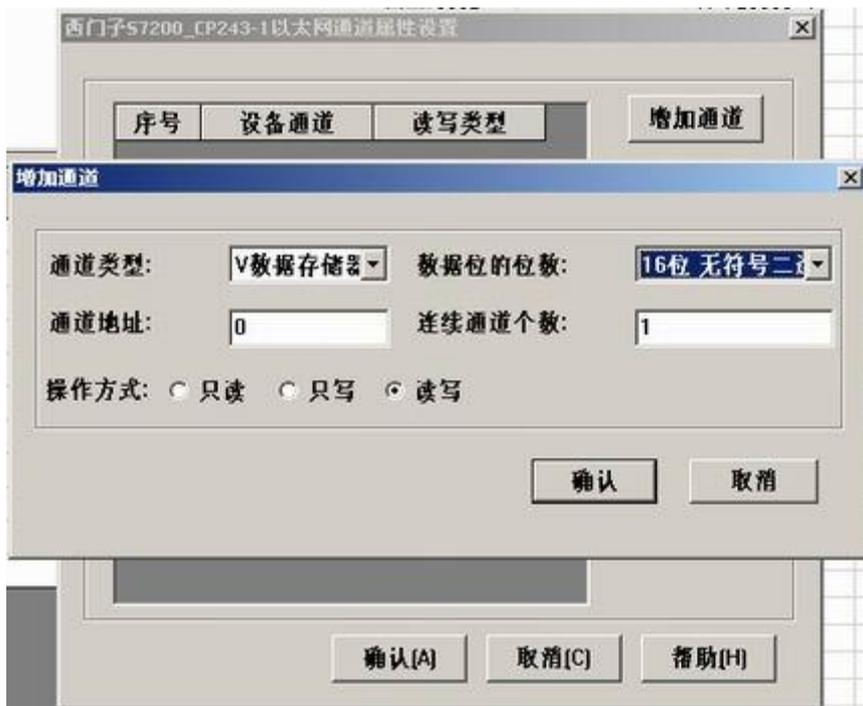
4、新建变量后点击“快速连接变量”，再点击“启动设备调试”，进行变量的监视
